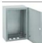
60041658 ЭРА SIMPLE ЩМП-07 IP31 (600x400x175) 230 / 400В, ≤400 А, IP54, УХЛ3, навесной, 600x400x175 мм, сталь, полиэфирная порошок. краска, цв. серый, RAL 7035
