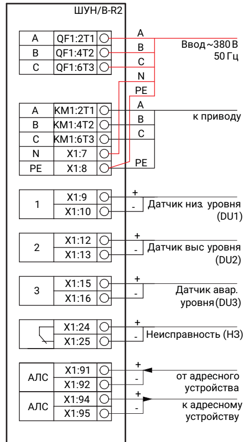
СХЕМА ВНЕШНИХ ПОДКЛЮЧЕНИЙ К ШУН/В-R2 на 18-45 кВт
