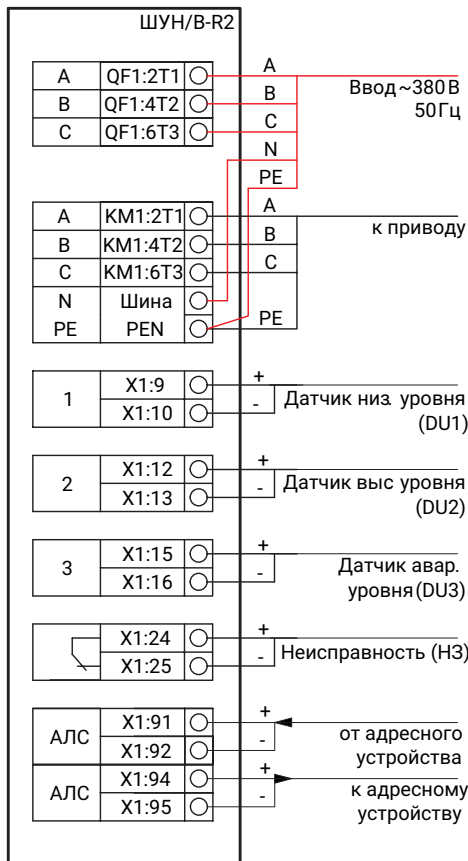
СХЕМА ВНЕШНИХ ПОДКЛЮЧЕНИЙ К ШУН/В-R2 на 55-110 кВт
