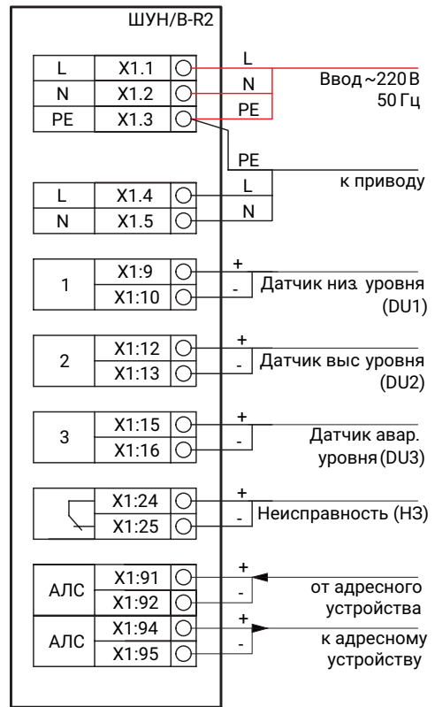
СХЕМА ВНЕШНИХ ПОДКЛЮЧЕНИЙ К ШУН/В-О-R2
