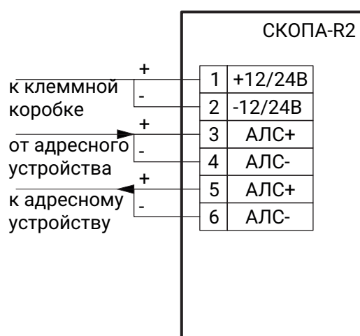
СХЕМА ПОДКЛЮЧЕНИЯ СКОПА-R2 К АДРЕСНОЙ ЛИНИИ СВЯЗИ
