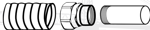
Резьбовой крепежный элемент с внутренней резьбой РКв для присоединения металлорукава к трубе электропроводки
